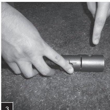
Assemblez le nouveau couplage de circulation à la tige supérieure avec une nouvelle goupille de chape en acier inoxydable et une nouvelle goupille fendue en acier inoxydable.
