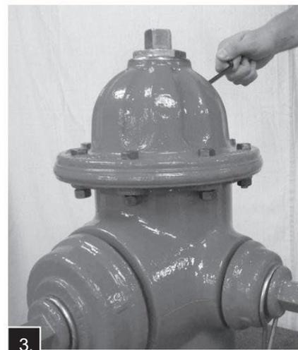
Lorsque l'huile est au niveau de l'orifice du bouchon de remplissage d'huile, remplacez le bouchon de remplissage d'huile.
